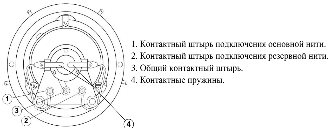
Рисунок 1. Линзовый комплект с двухнитевой лампой (вид со стороны монтажа).
